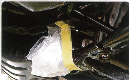
シフト塩カル防錆剤 上塗り
